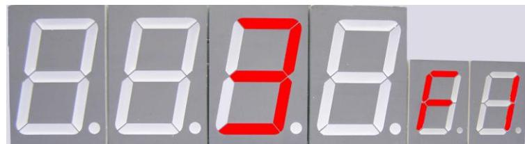
**4 F1** режим работы ТРК по 485 протоколу, управление ТРК производится системой управления (на системе управления набрать необходимое количество литров и снять на ТРК раздаточный кран, через 4 секунды включится насос ТРК).
