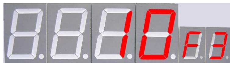
Цифра 10 на табло означает сетевой адрес топливораздаточного крана ТРК.
