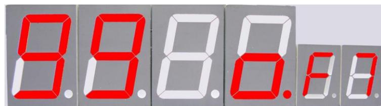
Цифры в начале табло 1-99 означают номер прописываемого ключа (каждый ключ имеет свой номер).
