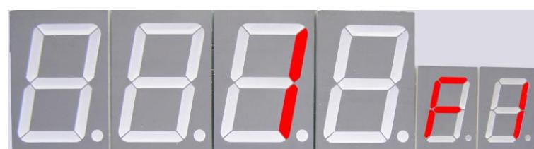
**2 F1** режим работы ТРК ручной (снять на ТРК раздаточный кран, набрать необходимое количество литров на клавиатуре ТРК, используя клавиши с цифрами, нажать клавишу «#» и подтвердить пуск красной кнопкой, через 4 сек., включится насос ТРК).
