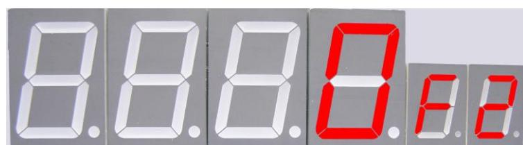
Для электронной корректировки дозы налива ТРК необходимо снять на ТРК раздаточный кран, вставить топливораздаточный кран в мерную емкость, приложить чип-ключ к его контактам на ТРК и нажать два раза клавишу "#", появится надпись " CAL "
