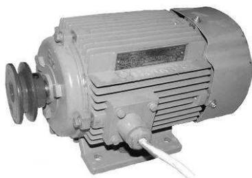
Электродвигатель создаёт вращательное движение, которое передаётся шкиву насоса моноблока через ременную передачу (см. рис. 1).
