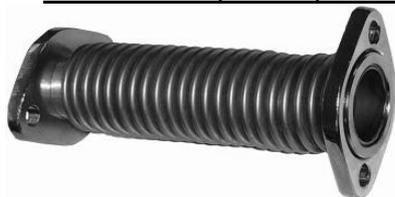
Компенсатор сильфонный предназначен для подсоединения гидравлической системы колонки к трубопроводу. Служит для компенсации осевых и продольных смещений трубопровода, вызванных неточностью монтажа, колебаниями температуры, давления, либо из-за наружного физического воздействия.
